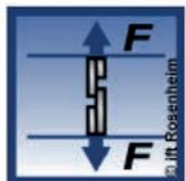
Bei der Bestimmung der Wärmebeständigkeit nach der Prüfvorschrift DIN EN 14257 (Watt 91) werden Zugscherfestigkeiten bei 80° Celsius von > 10 N/mm<sup>2</sup> erreicht. Empfohlen werden zur Herstellung von Fensterkanten lediglich > 7 N/mm<sup>2</sup>. Auch die bei der Beanspruchungsgruppe D4 (nach DIN EN 204/205) geforderten Zugscherfestigkeiten werden bei einigen Klebstoffsystemen deutlich überschritten.
