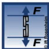
Lors de la détermination de la résistance à la chaleur sur la base de la norme de contrôle DIN EN 14257 (Watt 91), à 80 °C, on obtient des résistances à la traction et au cisaillement > 10 N/mm<sup>2</sup>. Pour la fabrication de carrelets de fenêtres, on recommande seulement une valeur > 7 N/mm<sup>2</sup>. Même les résistances à la traction et au cisaillement exigées pour le groupe de sollicitation D4 (sur la base de la norme DIN EN 204/205) sont largement dépassées.
