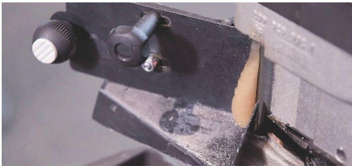
*/ Die Reinigung der Aggregate ist mit wenigen Handgriffen erledigt. Zunächst werden die Klebstoffreste abgelassen bzw. von der Auftragswalze abgerakelt. Dann ...*
