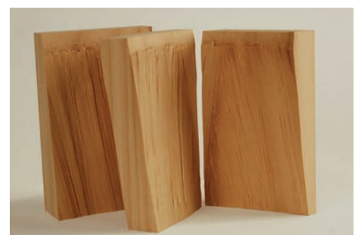
nach der Spaltung ... 100 % Holzbruch
