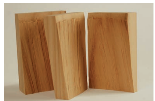
Dopo il test di rottura... 100% rottura del legno.
