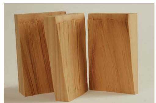
efter bryttest...100% fibersläpp
