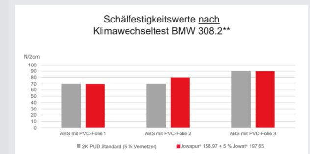
\*\*Die Ergebnisse beruhen auf Testreihen unter Laborbedingungen. Die Auftragsmenge betrug 50 - 60 g/m<sup>2</sup> trocken (Sprühauftrag). Eingesetzt wurden ABS-Träger und drei verschiedene PVC-Folien (beinhalten unterschiedliche Weichmacher). Auf Nachfrage stellen wir Ihnen gerne die genauen Prüfzyklen vom Klimawechseltest BMW 308.2 zur Verfügung.
