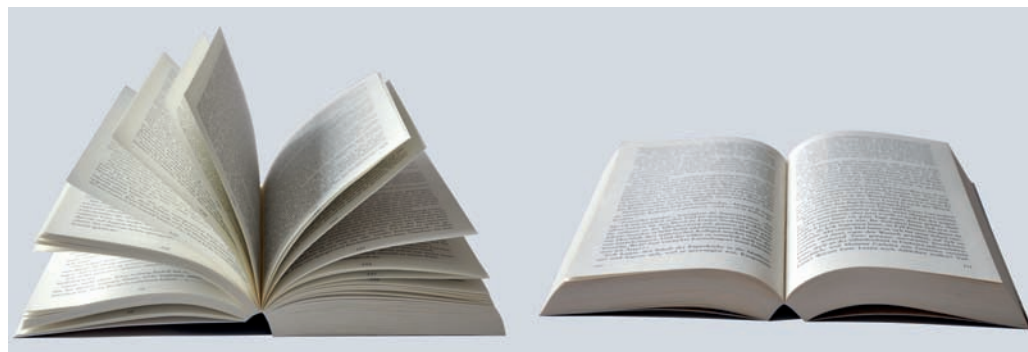
Lay-Flat-Vergleich: Das Buch rechts weist ein völlig flaches Aufschlagverhalten auf und wurde mit einem Jowatherm-Reaktant-Produkt geklebt. (Quelle: Jowat AG)
