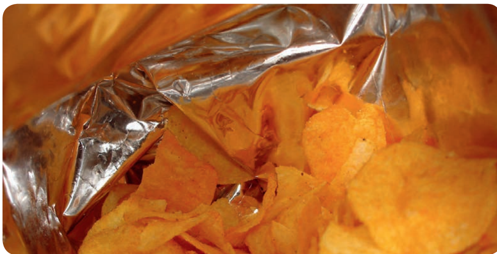
Verbundfolie mit Barrierefunktion gegenüber fettigen Füllgütern. (Foto: Jowat)
