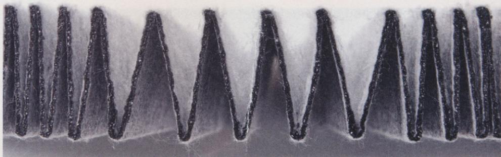
Plissier- und Rahmenklebstoffe ermöglichen eine lange Lebensdauer und hohe Qualität der Filterelemente
