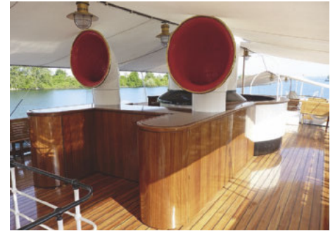
/ Die schichtverleimte Bar besteht aus Kambalaholz, in Form gehalten vom EPI-Klebstoff Jowacoll Five Star.
